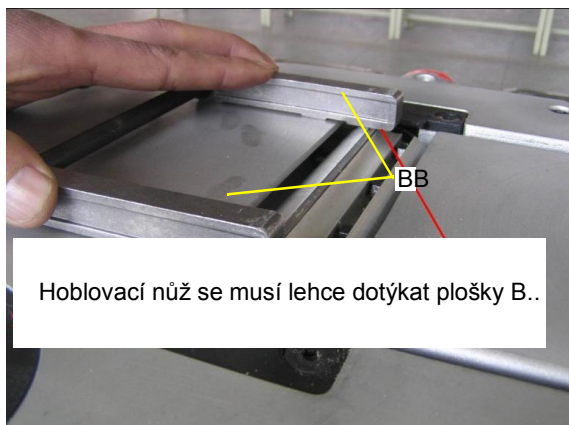
Obr. 27: Nastavení hoblovacího nože na plošku B
