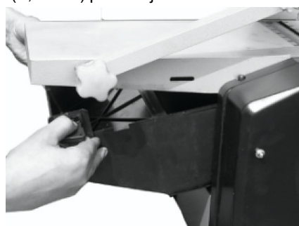
Obr. 11: Montáž odsávacího krytu
