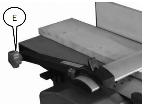
Obr. 16: Výškové nastavení krytu hoblovací hřídele
