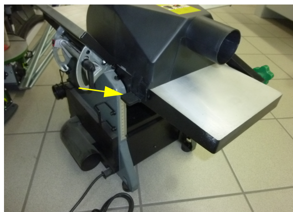
Obr. 24: Montáž odsávacího krytu
