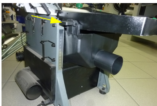
Obr. 20: Montáž odsávacího krytu
