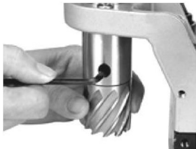
Obr. 12: Montáž jádrového vrtáku
