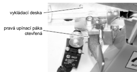
Obr. 3-12: Uvolnění upínací páky na vykládací desce
