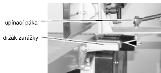
Obr. 2-10: Montáž zarážky na vkládací stůl (desku)
