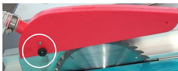
Obr. 15: Montáž ochranného krytu pilového kotouče
