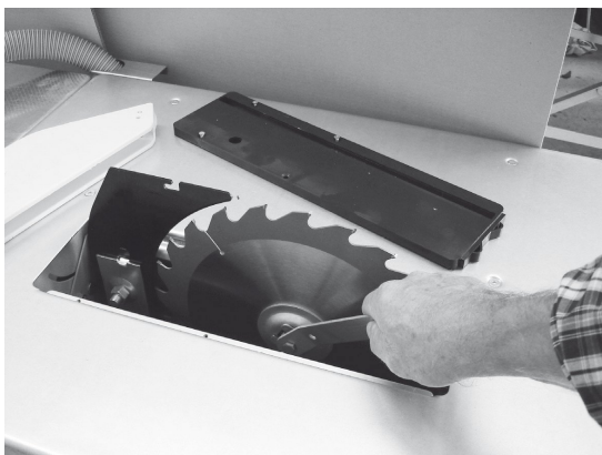
Obr. 38: Povolení pilového kotouče
