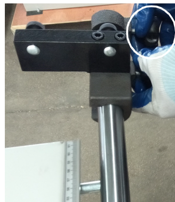
Obr. 8: Nasazení podpěry na vodící lištu
