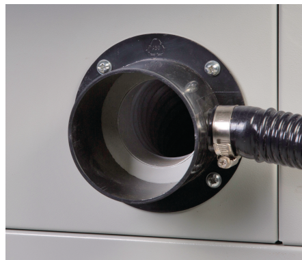
Obr. 14: Montáž přípojky odsávání
