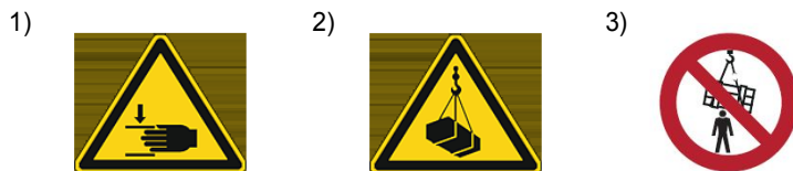
Obr. 1: Výstražné štítky (1 Nebezpečí přímáčknutí / 2 Varování před houpajícím se nákladem / 3 Zákaz pohybu pod nákladem)
