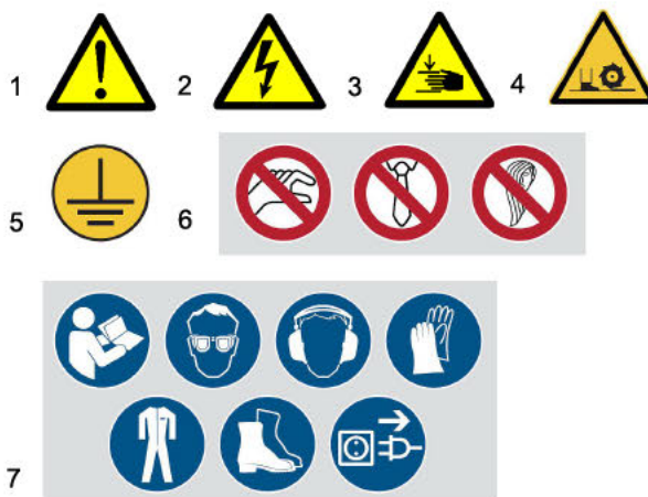
Obr. 1: Výstražné štítky - 1 Varování před nebezpečím | 2 Varování před nebezpečným elektrickým napětím | 3 Nebezpečí skřípnutí horních končetin | 4 Varování před otáčejícími se noži | 5 Uzemnění | 6 Zákaz | 7 Bezpečnostní pokyny, osobní ochranné pomůcky
