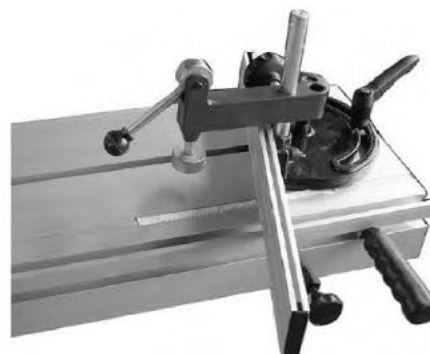
Obr. 10: Montáž úhlového dorazu
